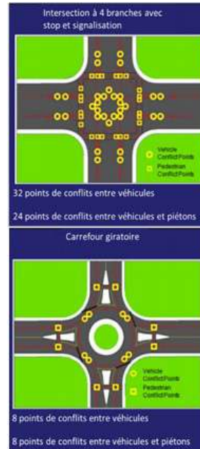
Figure 55. Points de conflits : comparaison intersection avec stop et carrefour giratoire. Source : Service d'Ingénierie de la ville de Vernon, avec une bonne lisibilité, à M'diq. Photo CID.
