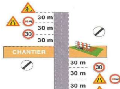
Figure 185. Exemple de disposition des panneaux pour un chantier qui rétrécit la voie libre à la circulation : photo et schéma. Source : Certu, fiche Les chantiers urbains, 2010 et site CFA-TP, formation en TP.
