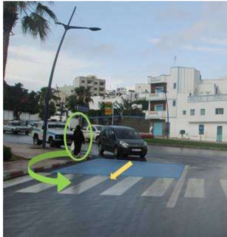
Figure 65: passage piétons à l'approche du giratoire avec une distance de sécurité en bleu dans la photo à gauche d'un carrefour giratoire à M'diq (en vert le cheminement d'un piéton et en orange la direction d'une voiture en sortie du carrefour). Source : élaboration et photo CID
