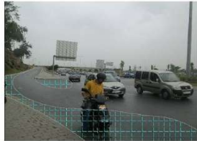
Figure 44. Voies en conflit non perpendiculaires avec en bleu clair l'espace qui pourrait être consacré au trottoir avec une meilleure sécurité et confort pour tous les usagers, y compris pour ce motocycliste dont la visibilité est rendue difficile par le caractère non orthogonal de la voie en entrée du carrefour. Esquisse d'aménagement du carrefour Av. Rahba près du Pont Hassan II.
