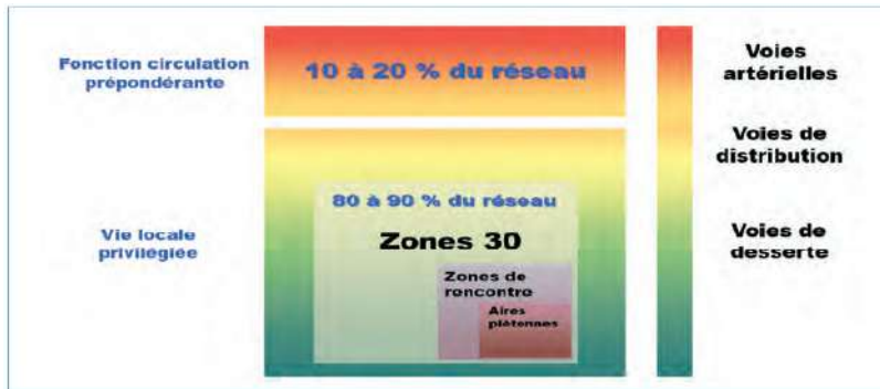
Figure 12. Hiérarchisation fonctionnelle du réseau viaire en milieu urbain. Source : Sécurité et hiérarchie des voies urbaines, Certu, 2008.
