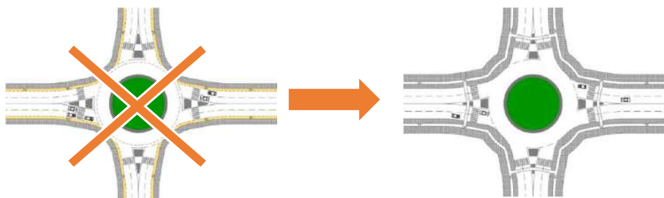
Figure 73. A gauche un aménagement par bande cyclable avec une faible sécurité. A gauche : le dessin qui a prouvé d’être le plus sûr au Pays Bas, avec piste cyclable séparée non prioritaire pour les cyclistes
