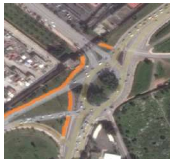
Figure 133. Exemple d'aménagement séparé sécuritaire pour les 2 roues (en orange) à proximité d'un grand carrefour giratoire à Rabat. Source : image satellite Google.
