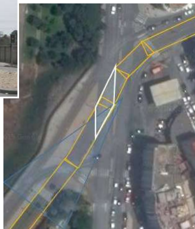
Figure 88. Intersection avec la plateforme d'un tramway: panneaux annonçant le régime de priorité favorable au tramway avec signalisation lumineuse, interdiction de certains mouvements tournants (ici depuis la sortie de la station d'essence sur la droite), différenciation de la section de la plateforme en intersection avec la chaussée (en premier plan dans la photo en haut et en blanc dans la prise satellitaire cicontre). Ci-contre : champs visuel de la photo dans le triangle bleu et site propre du tramway en orange. Source : CID, élaboration à partir d'image Google, Rabat.
