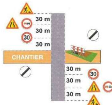
Figure 197. Exemple de disposition des panneaux pour un chantier qui rétrécit la voie libre à la circulation : photo et schéma. Source : Certu, fiche Les chantiers urbains, 2010 et site CFA-TP, formation en TP.
