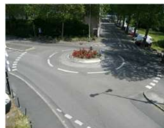
Figure 57. Exemple de mini-giratoire. Source : internet, France.
