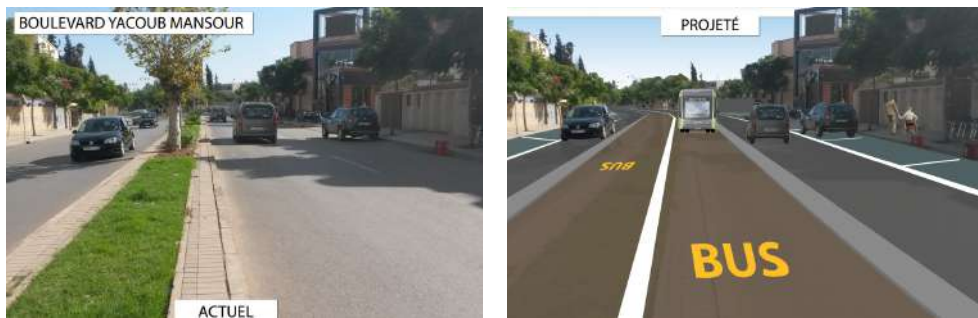
Figure 85. Aménagement en section courante du Bd Y. Mansour (image avant/après) pour accueillir un BHNS, à Oujda. Comme on peut voir, la démarche et les principes généraux d'insertion d'un site propre restent les mêmes que ce soit pour un tram ou un BHNS. Source : PDMU d'Oujda.
