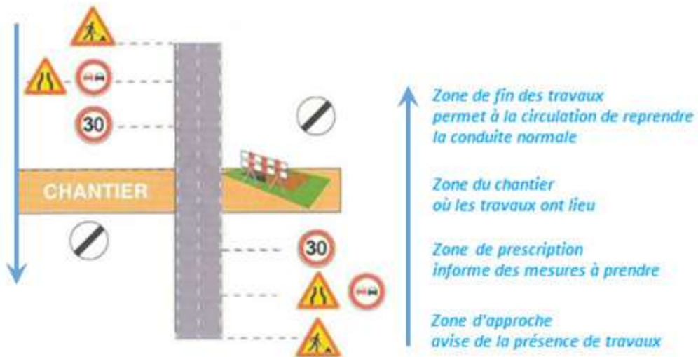
Figure 178. Schéma des 4 zones d'une aire de travail type. Source : élaboration CID sur schéma du site CFA-TP, formation en TP.
