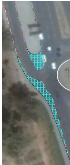
Figure 44. Voies en conflit non perpendiculaires avec en bleu clair l'espace qui pourrait être consacré au trottoir avec une meilleure sécurité et confort pour tous les usagers, y compris pour ce motocycliste dont la visibilité est rendue difficile par le caractère non orthogonal de la voie en entrée du carrefour. Esquisse d'aménagement du carrefour Av. Rahba près du Pont Hassan II.
