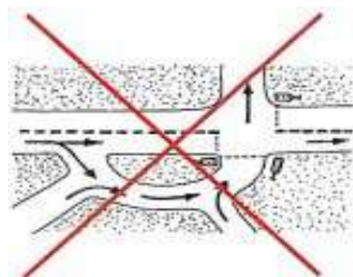
Figure 41. Les TAG s'écoulant par une voie à droite sont à proscrire car accidentogènes. Source : Certu 2010
