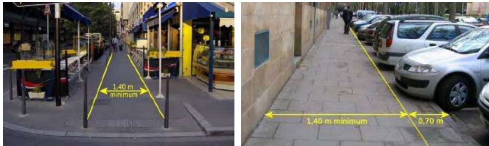
Figure 118. Largeur minimale de trottoir à garder libre de tout obstacle. Source : Certu, Profil en travers, 2010.
