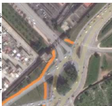
Figure 75. Exemple d'aménagement séparé sécuritaire pour les 2 roues (en orange) à proximité d'un grand carrefour giratoire à Rabat. Source : image satellite Google Maps.
